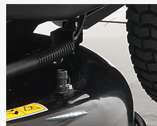
Spezielle Deckwaschdüse zur einfachen Reinigung
